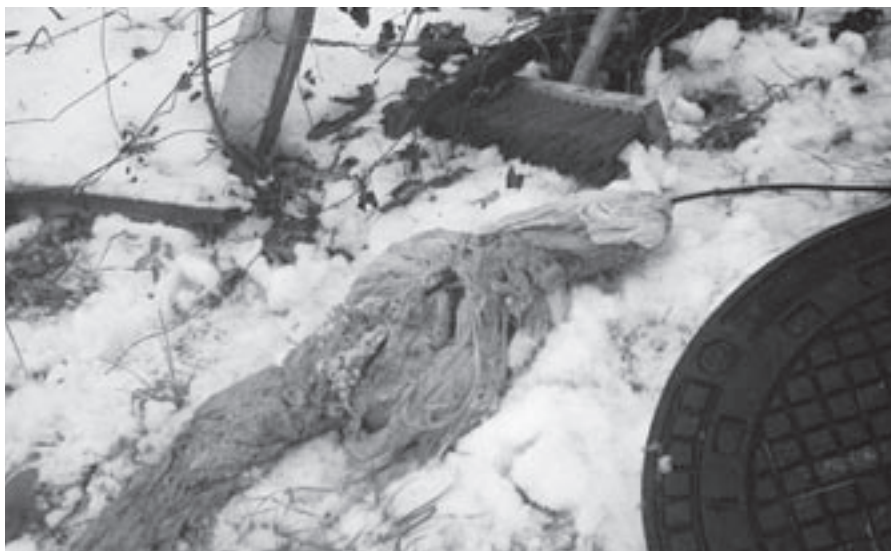
Die Feuchtigkeitstücher, Binden und Tampons dehnen sich aus und verklumpen sich ineinander, sodass solche Verunreinigungen entstehen. (Foto: Bauhof Arzl)
